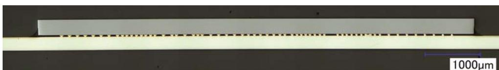
μ<sup>2</sup> Pack Schliff –Microcontroller mit 232 I/Os, 80μm pitch, 65μm Pads
