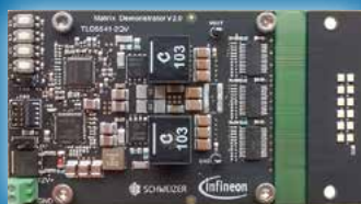
Inlay Board-Technologie ermöglicht Integration von LEDs und deren Ansteuerung in einer Leiterplatte
