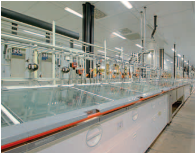
Durchkontaktierungsanlage zur Erzeugung einer leitfähigen Verbindung innerhalb der Bohrlöcher
